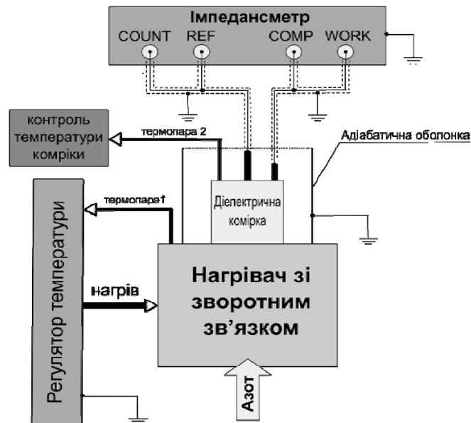
Рис. 2.6. Експериментальна установка для дослідження електрофізичних властивостей.
