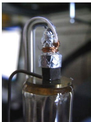
Рис.2.8. Фотографія зразку для дослідження п'єзорезистивного ефекту.
